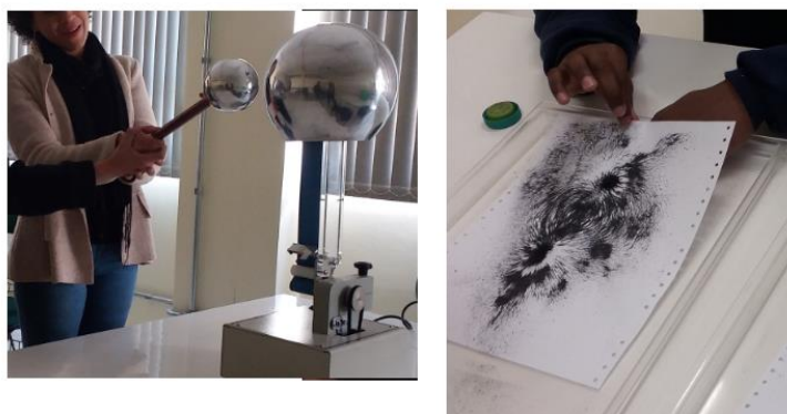
Figura 5. Interação com o gerador de Van de Graff, ímãs e limalha de ferro.
