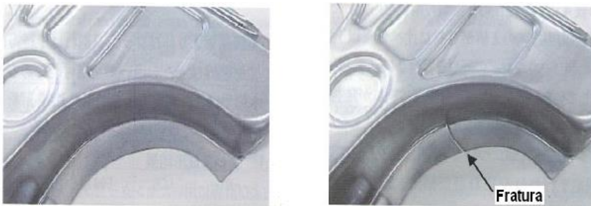
Figura 1. Peças produzidas em AHSS por estampagem (ambas). Na esquerda, corretamente conformada e na direita, com ocorrência de trinca. TEREPEDINO (2004).
