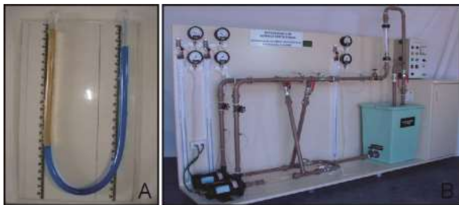
Figura 3 – Experimentos de (A) massa específica de líquidos utilizando o tubo em “U” e (B) associação de bombas centrífugas.
