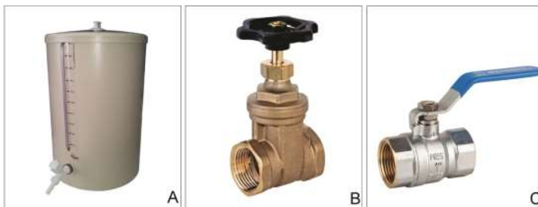
Figura 1 – Experimento de esvaziamento de tanque e válvulas utilizadas (A) Barrilete de PVC (B) Válvula gaveta e (C) Válvula esfera.
