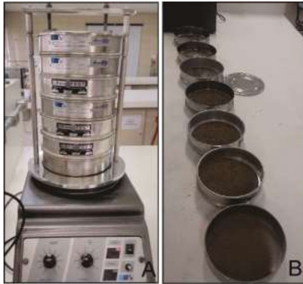
Figura 2 – Experimento de granulometria (A) agitador magnético e (B) amostra de solo em diferentes peneiras.
