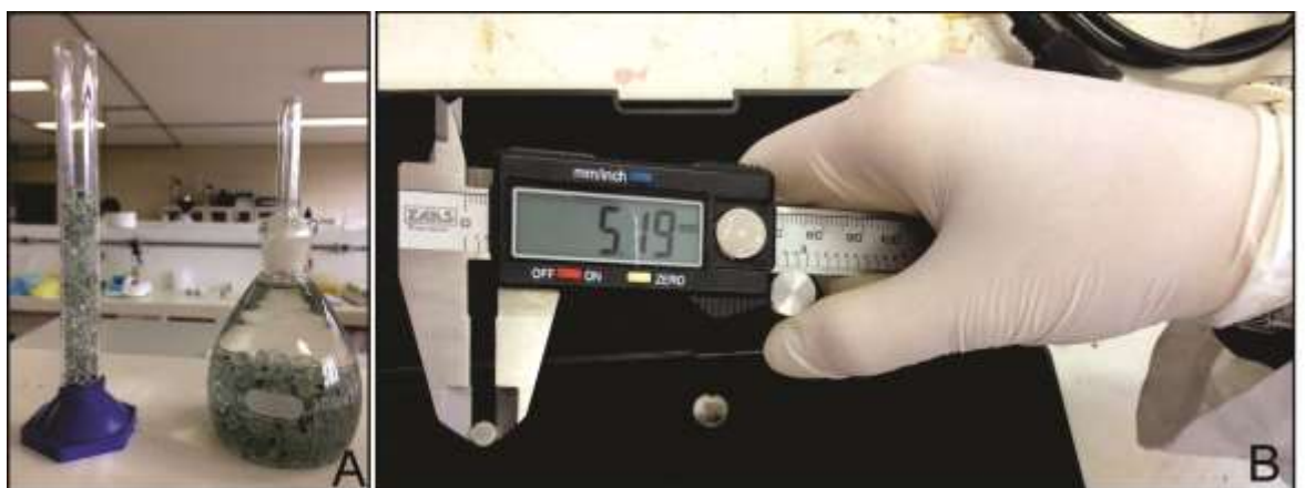
Figura 4 – Experimento de caracterização de partículas (A) proveta, picnômetro e (B) paquímetro digital.
