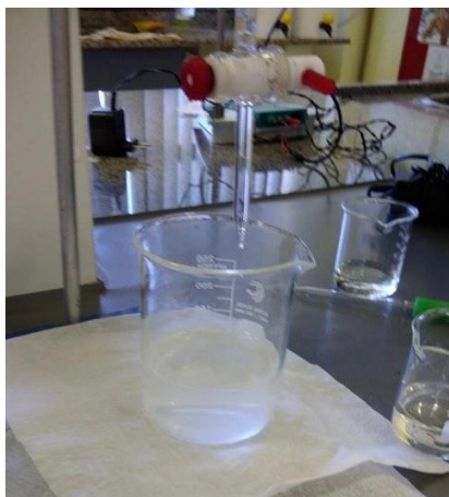
Figura 3: Amostra após titulação com HCl
