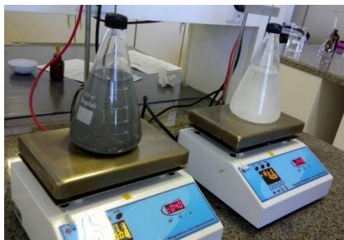
Figura 2: Erlenmeyers com a amostra e ensaio em branco durante a agitação magnética.
