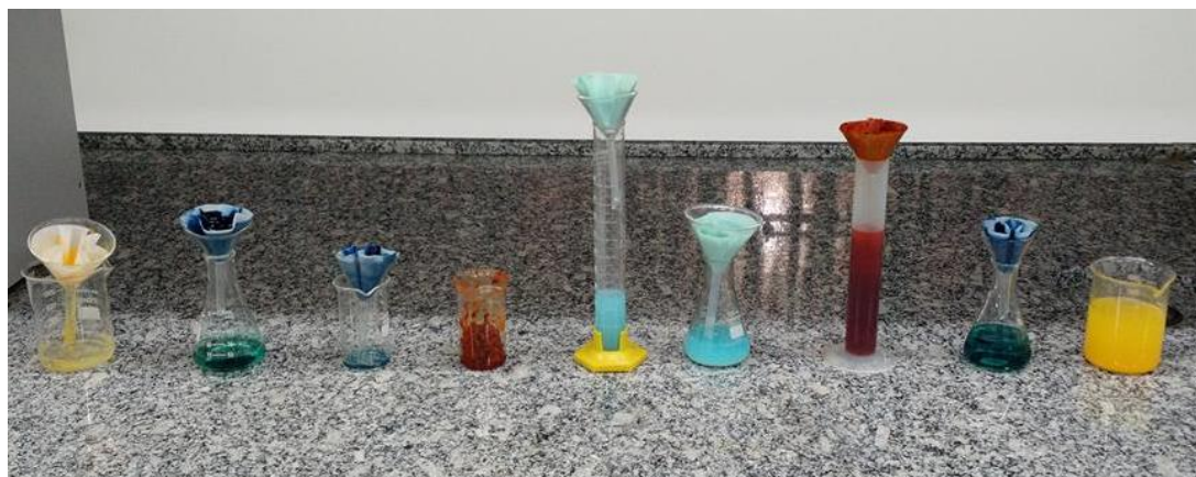
Figura 2. Precipitados dos procedimentos experimentais citados na Tabela 1, utilizados na confecção das tintas.
