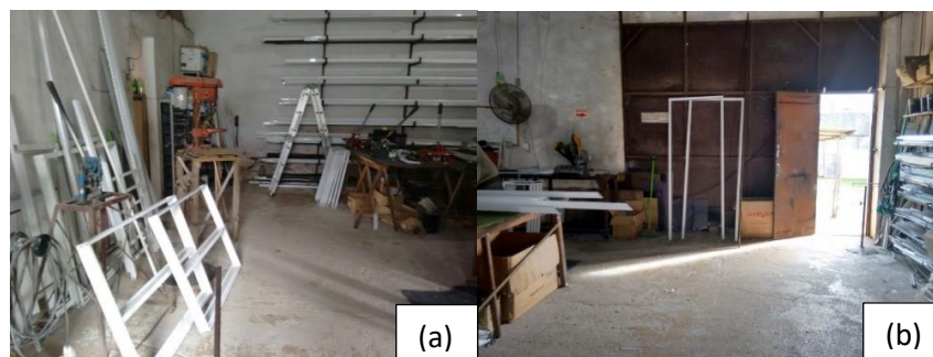
Figura 3: (a) mostra a falta de organização e preocupação de um local adequado para guardar equipamentos e produtos já prontos, (b) E possível notar que além da falta de organização das matérias que podem vir a causar acidente, também existe o bloqueio na abertura do que seria a saída de emergência, onde o portão tem sua abertura obstruída por um ventilador que está pregado na parede.
