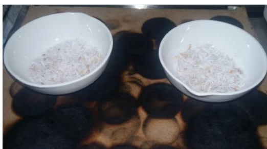
Figura 1. Sílica amorfa obtida a partir das cascas de arroz. (2017).
