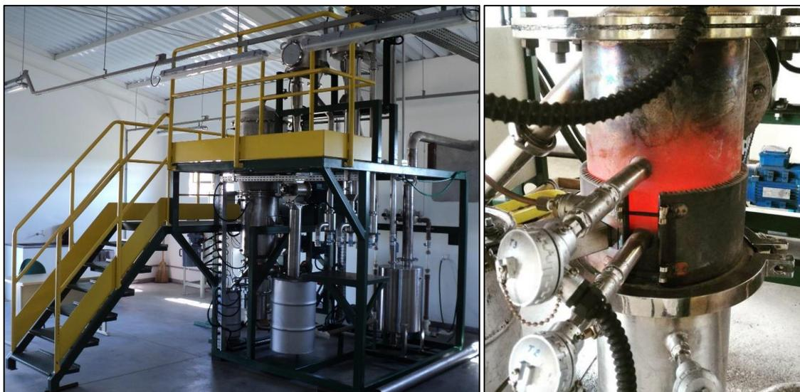
Figura 1. Planta piloto de gaseificação.
