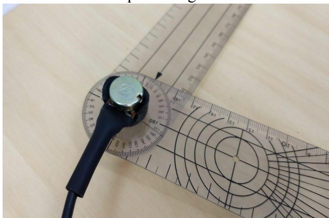
Figura 1: Potenciômetro 270° acoplado ao goniômetro.
