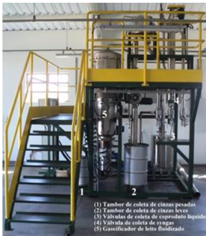
Figura 1- Planta de gaseificação presente no Laboratório de Energia e Carboquímica.
