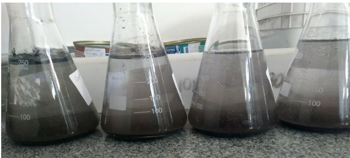
Figura 2- separação das amostras por densidade depois de 24h.
