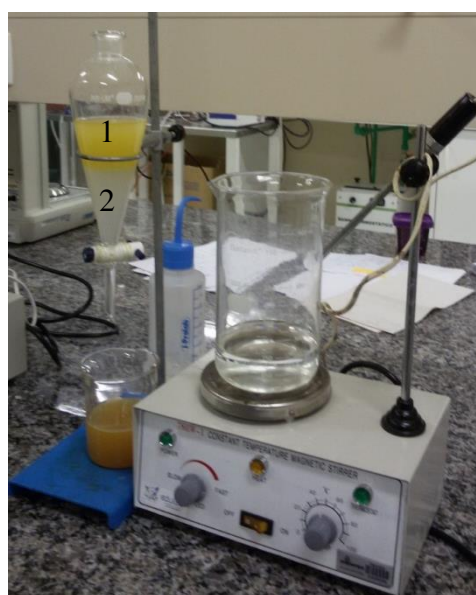
Figura 2: Kit montado e Biodiesel obtido. (1) biodiesel e (2) resíduo.
