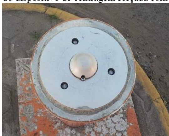
Figura 3 – Detalhe do dispositivo de centragem forçada com cúpula de proteção.
