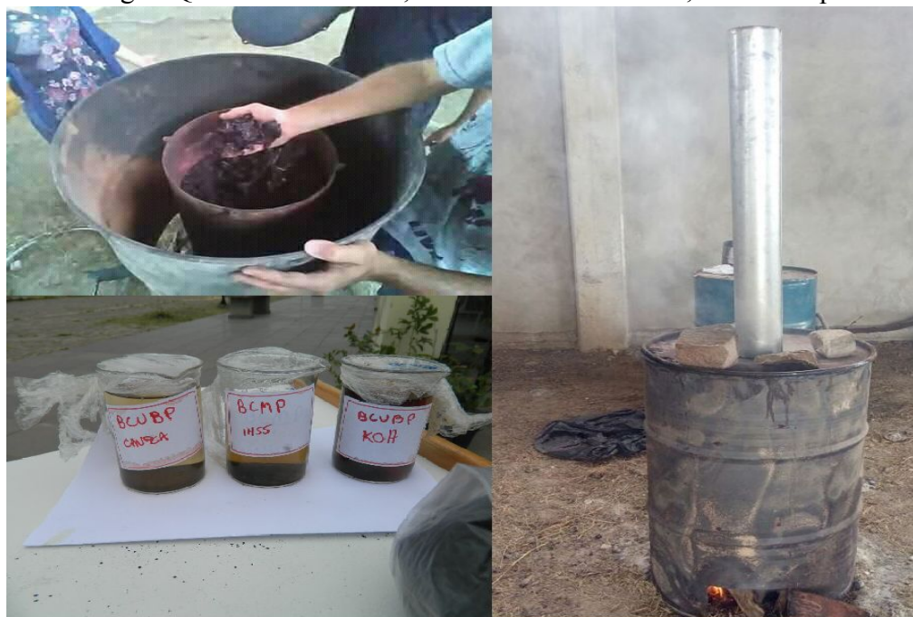
Fig.2: Queima de resíduos; Amostras de biocarvão; Reator de pirólise
