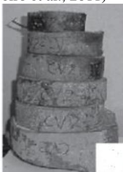
De cada amostra foi obtido o volume saturado e a massa seca, dados com os quais obtém-se a massa específica ( $Meb$  em  $g/cm^3$ ), conforme a fórmula abaixo:
