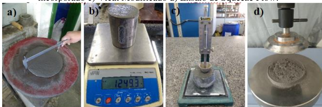
Figura 1 – Ensaios Reológicos de caracterização. a) Ensaio de Flow Table b) Densidade e ar incorporado c) Vicat Modificado d) Ensaio de Squeeze Flow.
