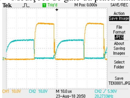
Figura 4 – Medições de gate da placa final
