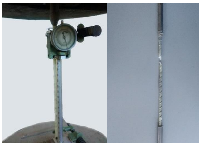
Figura 3 – Esquema do ensaio de tração e módulo de elasticidade.
